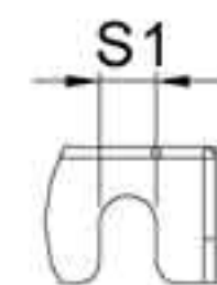
B (монтажное отверстие)
